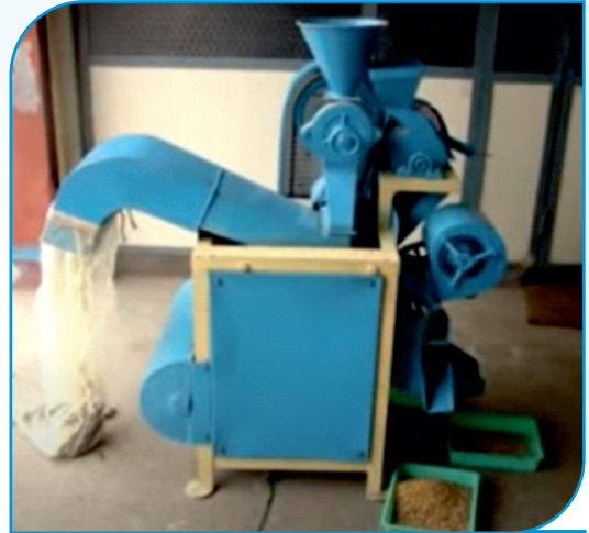
தமிழ்நாடு வேளாண்மைப் பல்கலைக்கழகத்தால் உருவாக்கப்பட்ட மேம்படுத்தப்பட்ட பயறு உடைக்கும் இயந்திரம்
